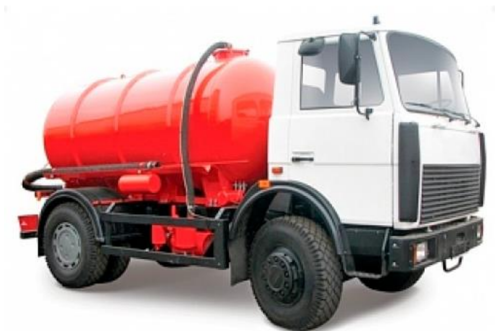
Асенізаційна машина КО-503В10, ємність цистерни 9,0 м 3
