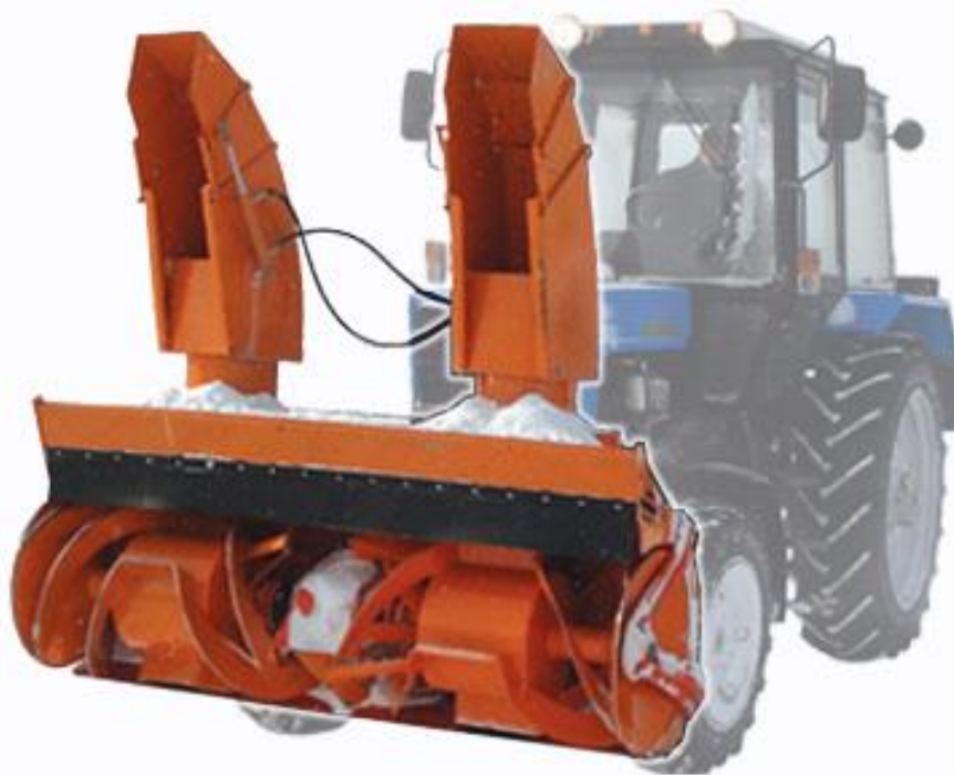
Навісний фрезерно-роторний снігоочисник СУ-2.1 (ширина захвату 2,1 м, дальність відкидання снігу – 2-25 м, продуктивність – до 600 т/год., робоча швидкість – 1,8-18,4 км/год.)
