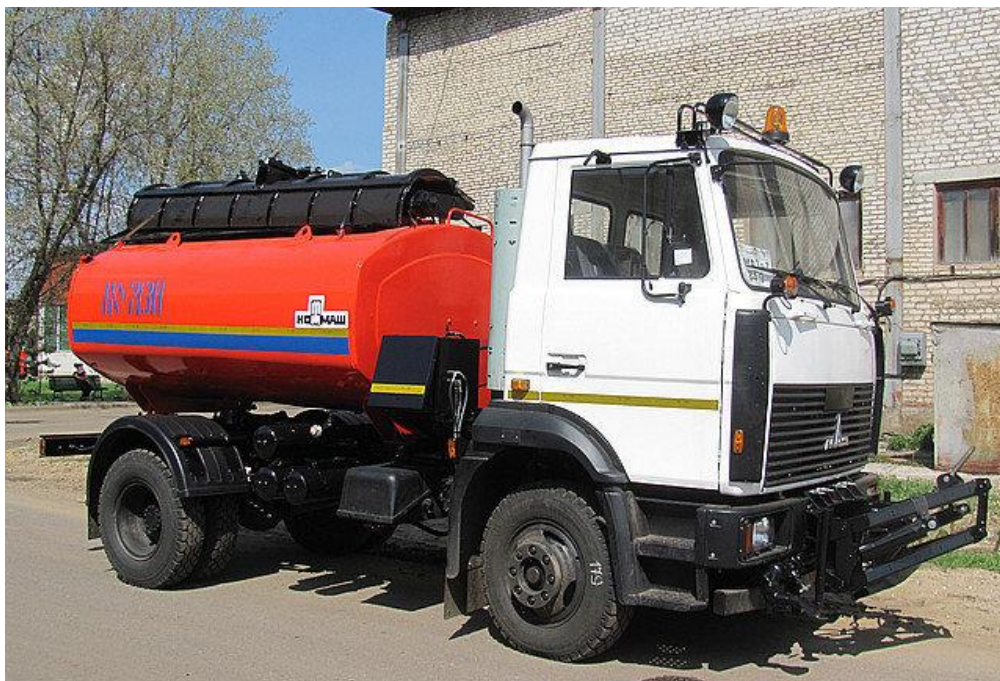
Поливально-мийна машина КО-713Н-41 Модель шасі - МАЗ-438043, ємність цистерни – 6,0 м 3 , максимальна ширина робочої зони при поливанні (митті) – 20,0 (8,5) м
